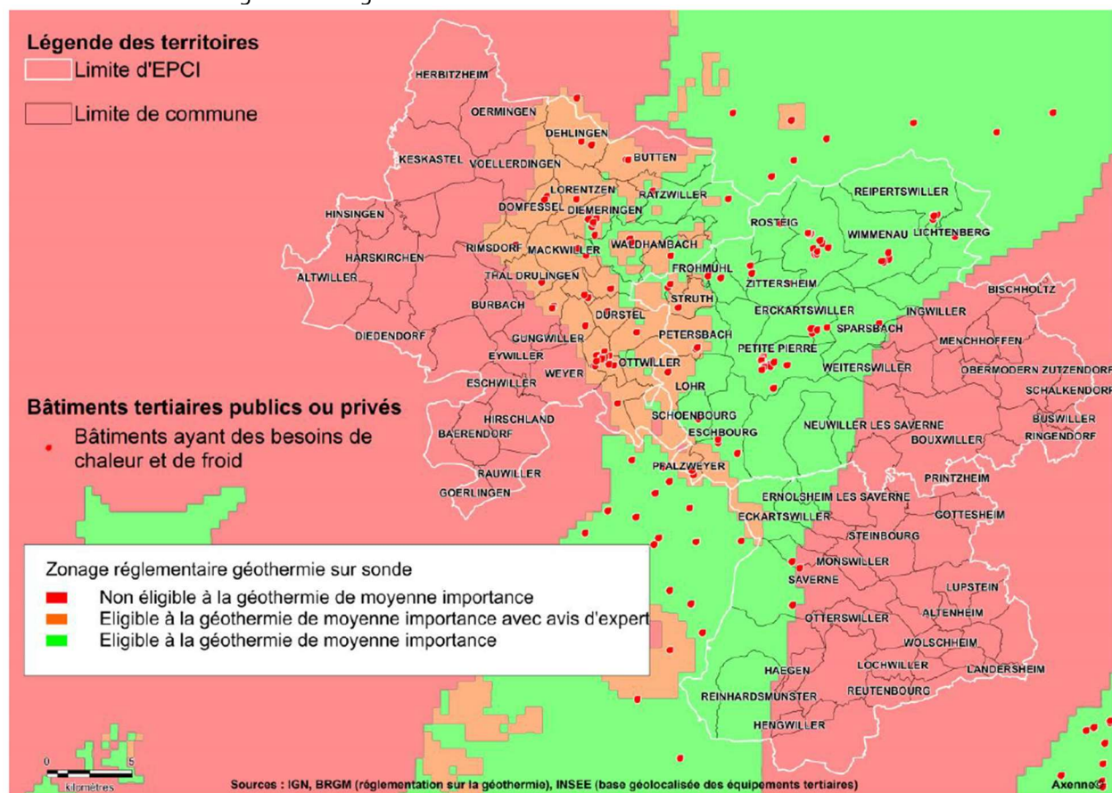
Carte réglementaire pour la réalisation de projet de minime importance sur sonde – source BRGM
